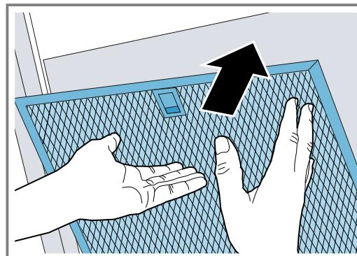
3. Ak bol tukový filter vložený nesprávne, opatrne zatlačte blokovanie dopredu, vyberte tukový filter a vložte ho správne.
