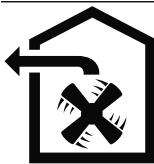
Vzduch sa nesmie odvádzať komínom, ktorý sa používa na odvod odpadových plynov zo spotrebičov, ktoré spaľujú plyn alebo iné palivá (neplatí to pre spotrebiče s cirkulačnou prevádzkou).
