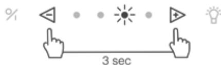
Le temps d'arrêt différé est à nouveau programmé sur 10 minutes (au lieu de 30 minutes) et le témoin de remplacement pour le recyclage de l'air est désactivé.
