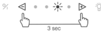
Nachlaufzeit ist wieder auf 10 Minuten eingestellt (anstelle von 30 Minuten) und die Reinigungsanzeige für die Rezirkulation ist ausgeschaltet.
