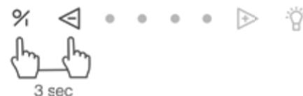
De functie kan ingeschakeld worden door de toets **1** en toets **3** tegelijk in te drukken voor 3 seconden. De 2e en 3e LED knipperen keer ter bevestiging (Het toestel moet uitgeschakeld zijn).
