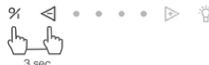
La fonction peut être activée en appuyant simultanément sur les touches et pendant 3 secondes. Les 2ème et 3ème LEDs clignotent 3 fois pour con rmer. (L'appareil doit être éteint).
